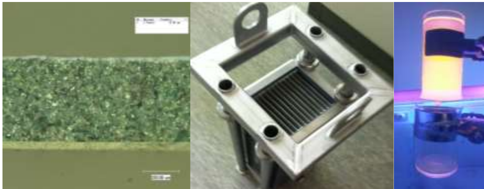
Glasgebundene Mehr-Kanal-Elemente (MKE) auf SiC-Basis für die getauchte Anwendung
