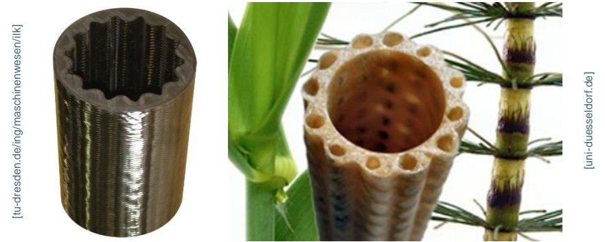
Kohlenfaserverstärkte Antriebswelle vs. Bambusrohr
