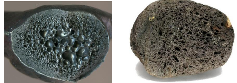
Geschäumtes Thermoplast-Bauteil vs. Vulkangestein
